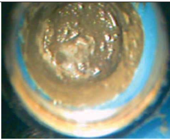
Foto 7: Docementování vrtu, průměr otvoru 33 mm, hloubka 7 m
