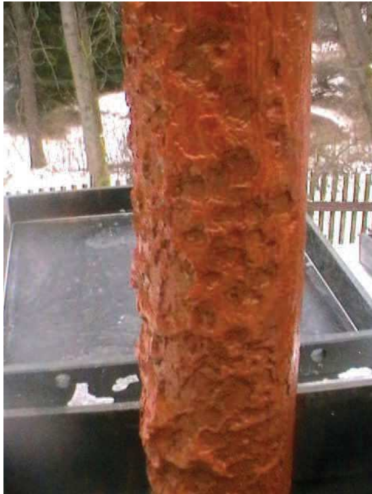
Obr. 1 Oxo-hydroxidy železa na povrchu nerezové výstroje.
